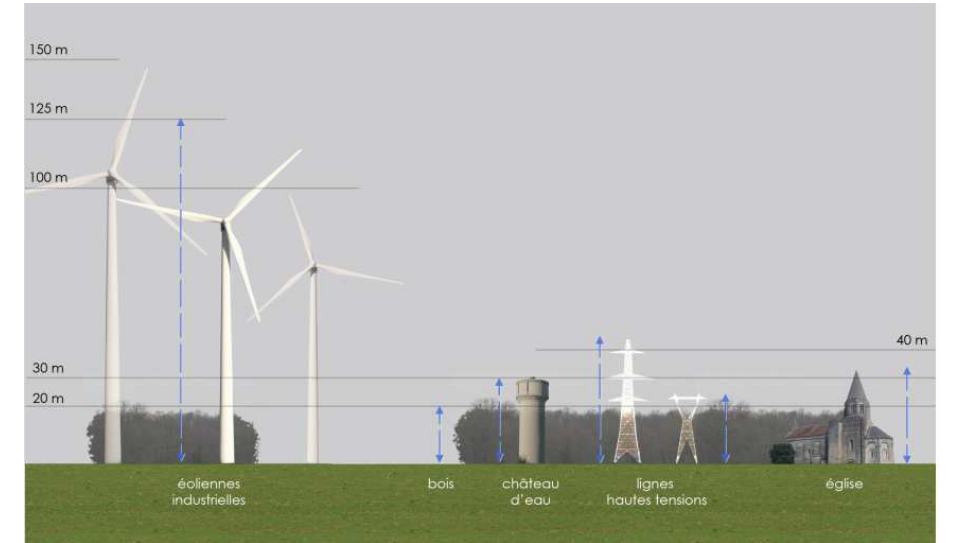
Principe des rapports d'échelles entre l'éolien et les autres éléments verticaux dans le paysage (source Agence Epure paysage)
